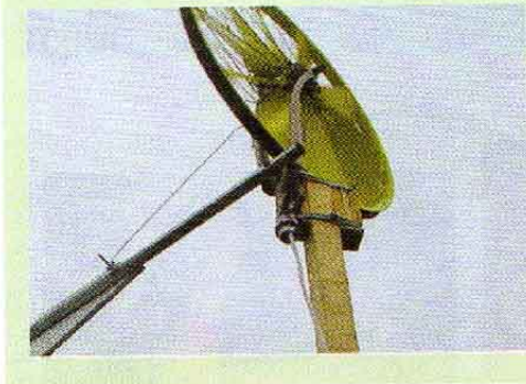
Fig. 3: Turbina che mostra il cavo inserito al centro dello sterzo per impedirne l'aggrovigliamento.
